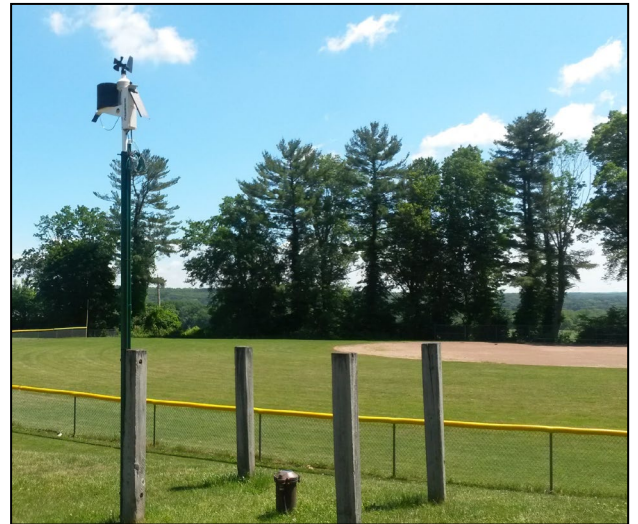
Una estación meteorológica debidamente ubicada.
