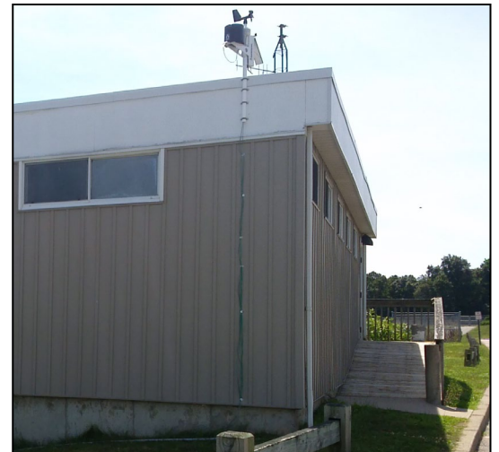
Una estación meteorológica mal ubicada.
